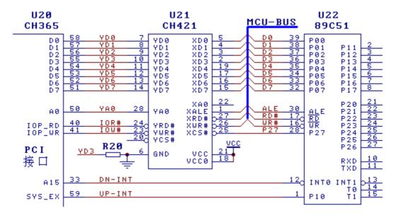
CH365 是 PCI 总线通用接口芯片,由于 CH365 提供的本地端口也是主动并行接口,所以不方便直接与单片机相连接。图中通过 U21(CH421)在 U20(CH365)与单片机 U22 之间提供双向数据缓冲,实现两者的异步数据交换。
