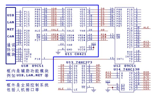
U10 是辅助单片机,专门负责处理复杂的网络通讯协议。U12 是主控单片机,负责全局事务,其系统总线上挂接了多个外围设备,地址 A7~A0 由锁存器 U13 提供,U14 负责全局地址译码,产生各外围设备的片选信号。U10 通过 U11(CH421)挂接到 U12 的系统总线上,成为 U12 众多外围设备中的一个功能模块。由于 U10 专门处理通讯协议,只在数据收发完成并且校验通过后才以中断方式通知 U12,所以 U12 只需要考虑在应用层收发数据,而不需要考虑各种复杂的通讯协议。
